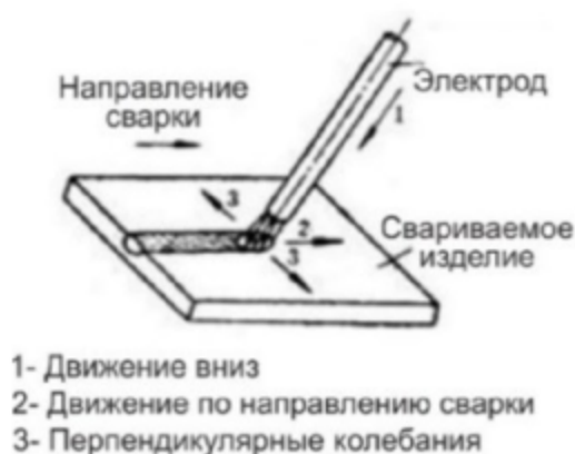
Рисунок 13.4 Три основных направления движения электрода
