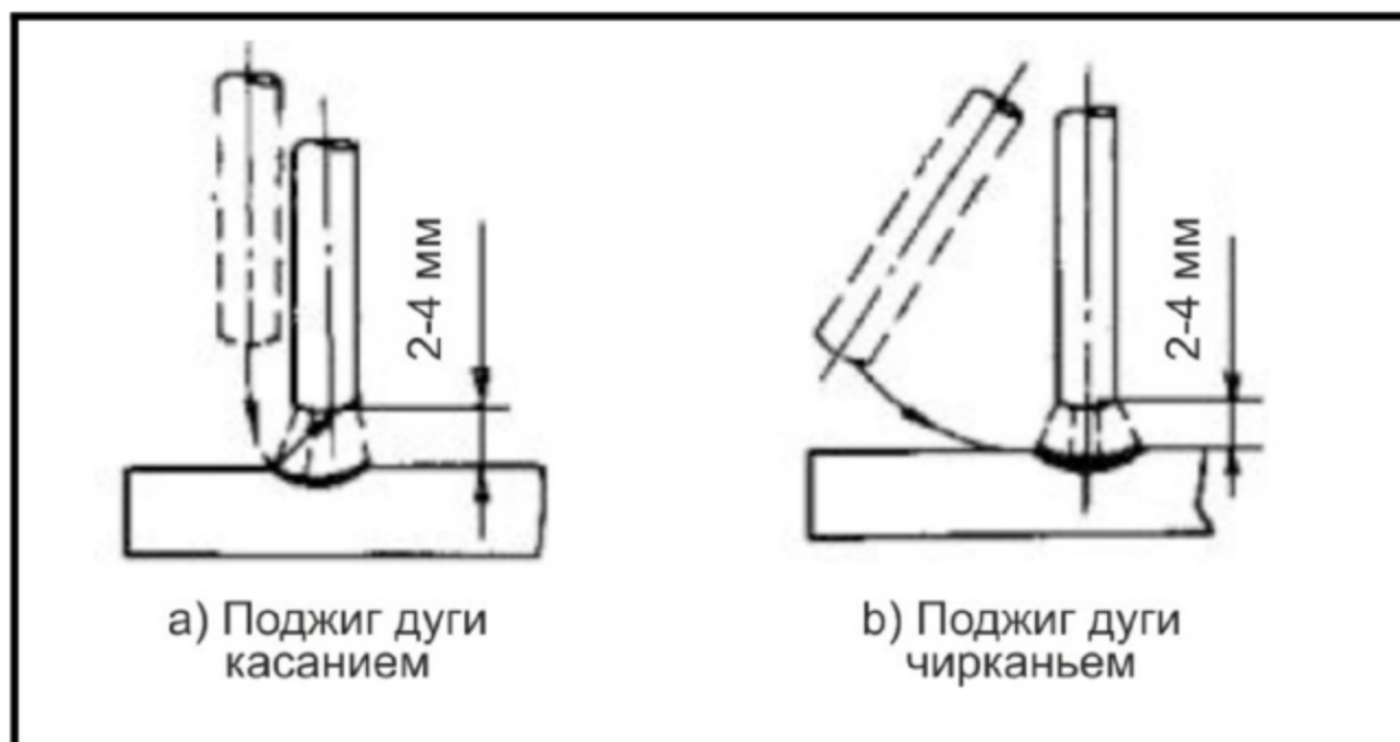
Рисунок 13.3. Способы поджига дуги.
